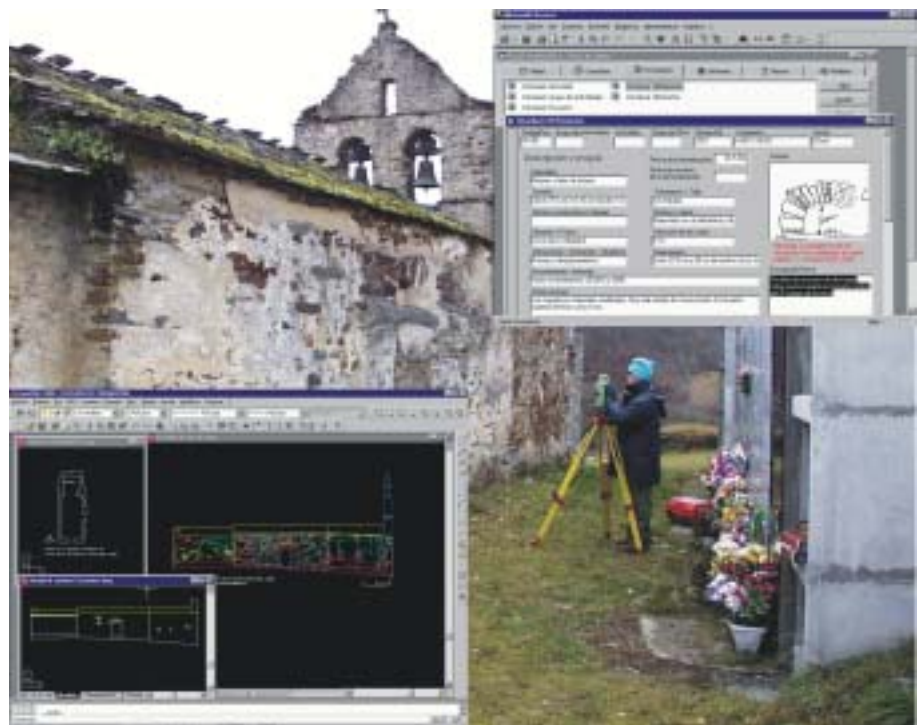
Fig. 6. Distintas fases del proceso de trabajo: toma de datos en campo, elaboración de la planimetría e introducción de datos en un archivo informático
