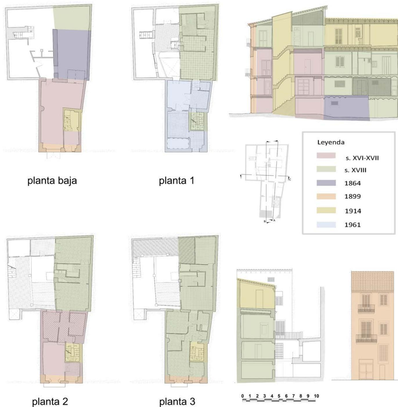
Figura 16. Hipótesis de las etapas de construcción y transformación del edificio de viviendas en la Calle Maldonado 33 (Valencia). Autores: Mileto y Vegas
