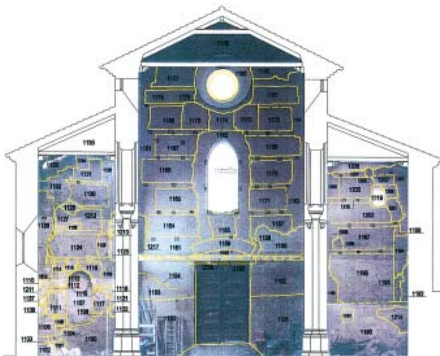
Fig. 3. Plano de análisis estratigráfico del alzado Oeste interior de la iglesia de San Juan de los Reyes (Granada)
