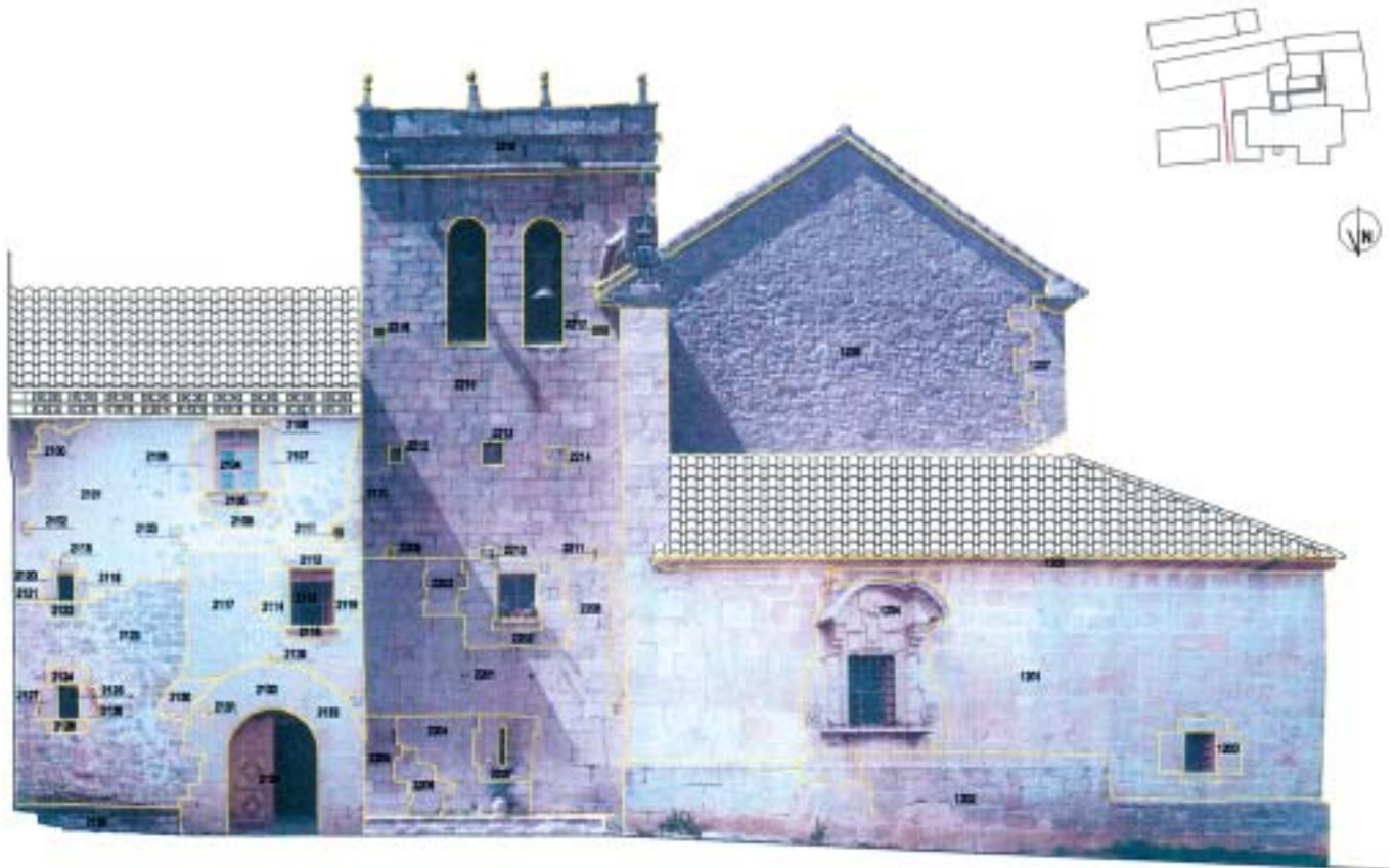
Fig. 1. Plano de análisis estratigráfico del alzado Este del Santuario de San Juan de la Peñagolosa (Castellón)
