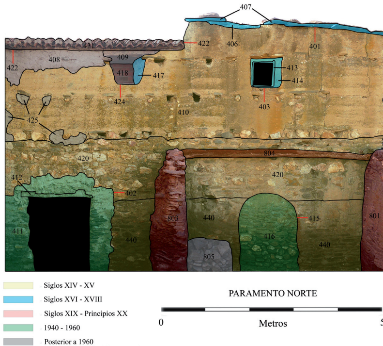
Fig. 27. Lectura estratigráfica del paramento norte de El Fuerte. En rojo están marcados las interfaces
