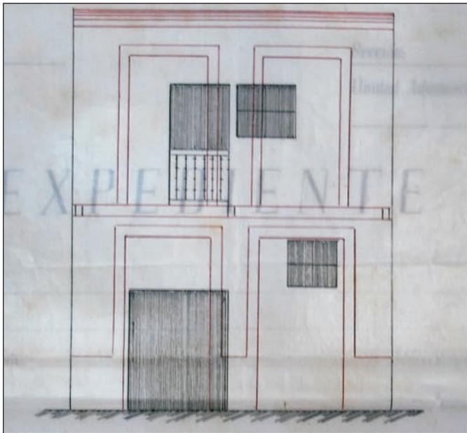
Fig. 36. Casa nº 21 (A.M.O.), con la reforma de 1889 en líneas rojas superpuesta a la fachada previa
