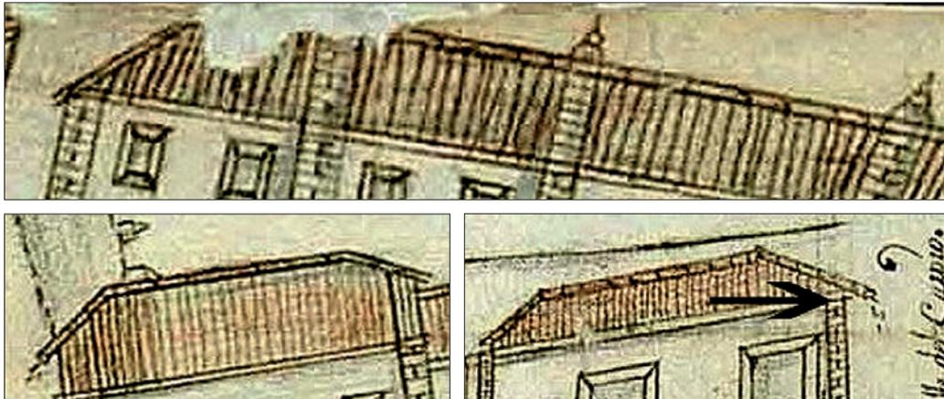
Fig. 19. Arriba, tejados de la manzana de casas del Postigo, abajo, a la izquierda, tejado de la casa del conde de Nava y tejado de la casa de Inclán, con el sistema de evacuado de aguas mediante una conducción de tejas situada en la cumbre de la techumbre. El dibujo de la casa de Inclán reproduce uno de esos momentos de vertido (señalado por la flecha)
