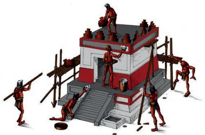
Figura 15. Dibujo reconstructivo del andamio y su utilidad para darle mantenimiento al edificio. Dibujo de Víctor Germán Álvarez Arellano.
