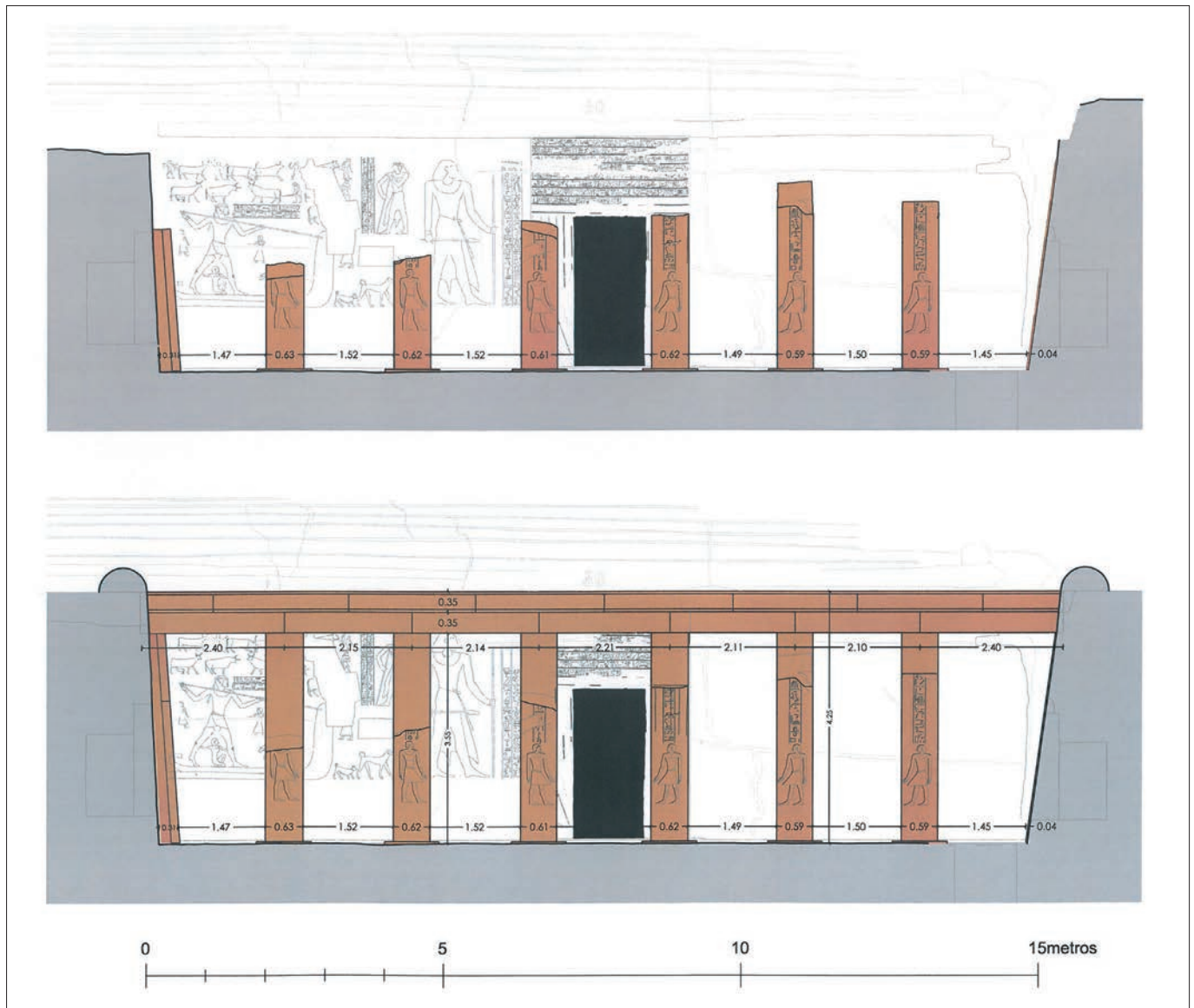
Figura 13. Pórtico de pilares que preside la fachada del patio del complejo funerario de Sarenput I (QH36). En la parte superior, estado actual; y en la inferior, reconstrucción.
