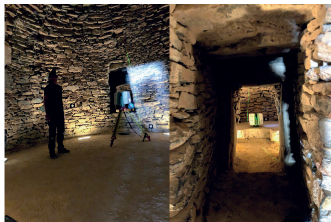
Figura 7. Posicionamiento de equipo TLS Leica C10 en las cámaras funerarias. La pequeña dimensión del pasillo que las comunica obliga a un nuevo estacionamiento intermedio. Elaboración propia.
