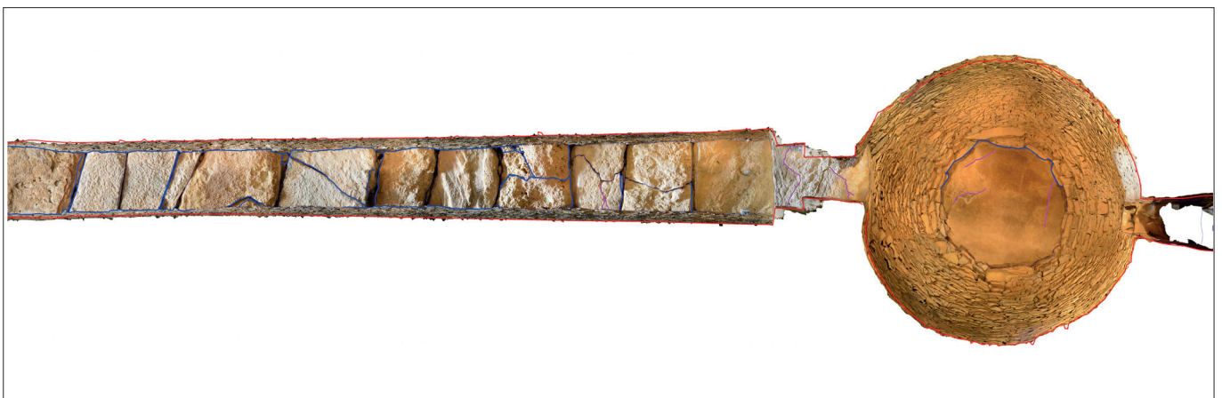
Figura 19. Análisis y dibujo de los ortostatos de techo en corredor y cámara con indicación de las grietas y fisuras a partir de ortofotografía escalada. Elaboración propia.
