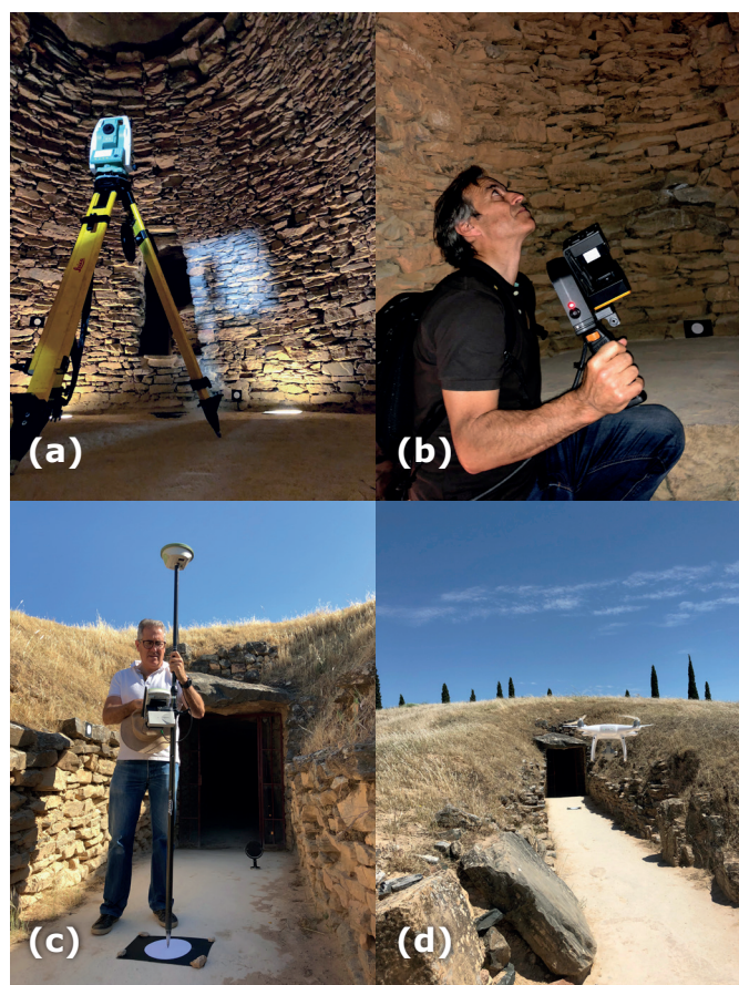
Figura 6. Instrumentos utilizados en la documentación del tholo de El Romeral. (a) Estación Total Leica TS06 para medición puntos de control, (b) Escaner MMS Zeb-Revo, (c) Sistema DGPS-Leica 1200, (d) Drone DJI Phantom 4 pro. Elaboración propia.
