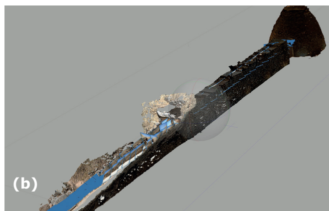
Figura 9. (a) Captura fotográfica del interior del corredor con cámara Nikon D800 y objetivo fijo Nikkor 14mm. (b) Captura del modelo digital 3D de la nube de puntos densa del interior generada por fotogrametría multi-imagen mediante la aplicación Agisoft Photoscan profesional. Elaboración propia.
