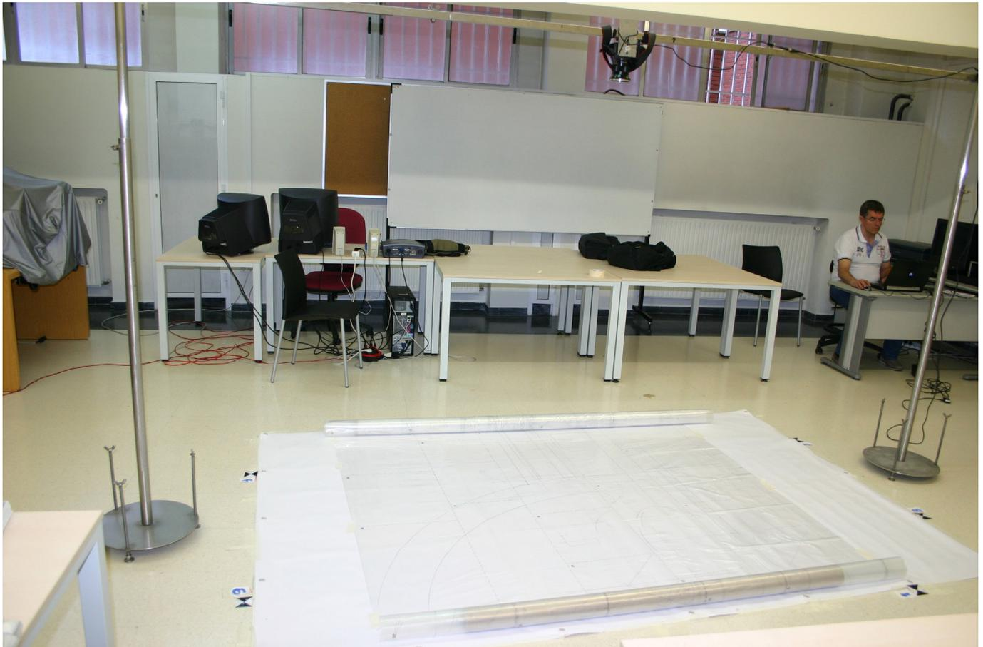
Figura 2. Dispositivo de toma con la cámara suspendida y gobernada desde el equipo portátil, la lona blanca de fondo, las marcas para escalar cada imagen y una de las láminas de plástico enrollada alrededor de un cilindro de cartón. (Foto A. Rodríguez, 2016).
