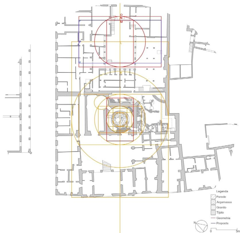
Figura 21. Proposta para a dimensão total do *Natatio* resultando do cruzamento entre a largura do rectângulo de ouro O e o comprimento do rectângulo de ouro M.
