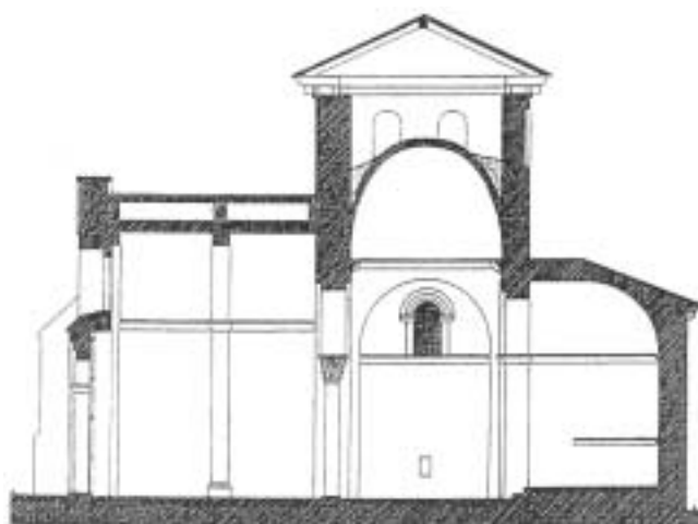
Fig. 4. Sección longitudinal estado final
