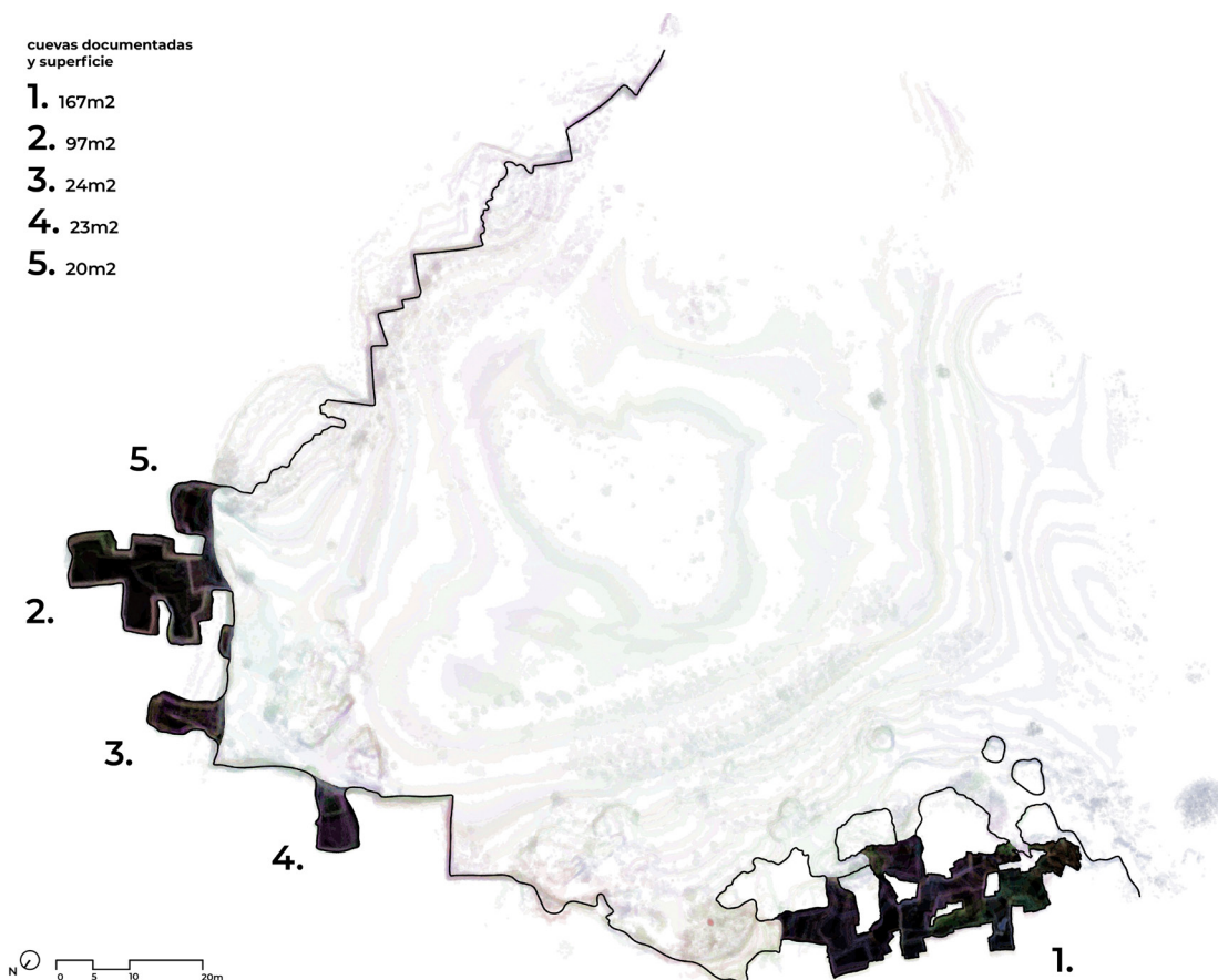
Figura 2. Planta de la cantera y del conjunto de cuevas de la Batida documentadas, junto con su superficie. En negro los espacios subterráneos del yacimiento. Realizado a partir del levantamiento tridimensional mediante nube de puntos. Elaboración propia.
