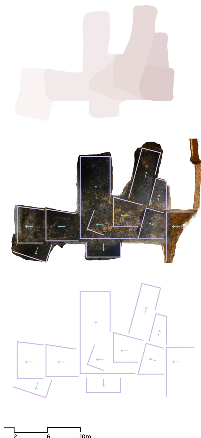
Figura 13. Análisis del avance del proceso de extracción de la cantera, según la identificación las marcas y diferencia de alturas del techo a partir de la ortofoto cenital de la cueva se traza la composición geométrica simplificada de cada una de las naves. (a) resumen de las fases y avances de la excavación en función de las cotas del techo. (b) identificación de los cambios de alturas del techo sobre la ortofoto de la planta especular del techo de la cueva. (c) diagrama de las fases y direcciones de la explotación, así como análisis geométrico de los espacios generados. Elaboración propia
