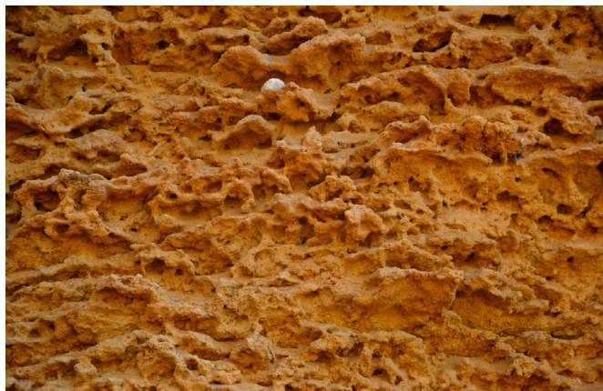
Figura 4. Detalle en el que se aprecia la estructura porosa de la piedra de alcor. Fuente: Servicio de Arqueología, Museo de la Ciudad de Carmona.
