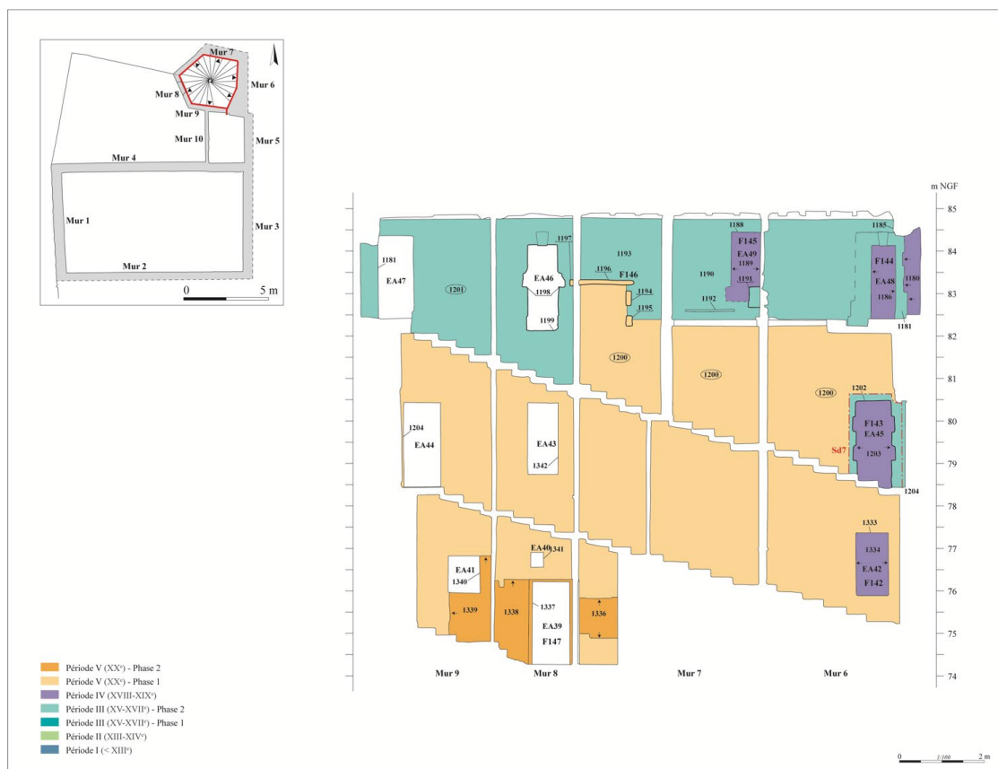
Figure 33. Lecture stratigraphique et phasage de l'intérieur de la tour d'escalier (Mur 6, 7, 8 et 9).
