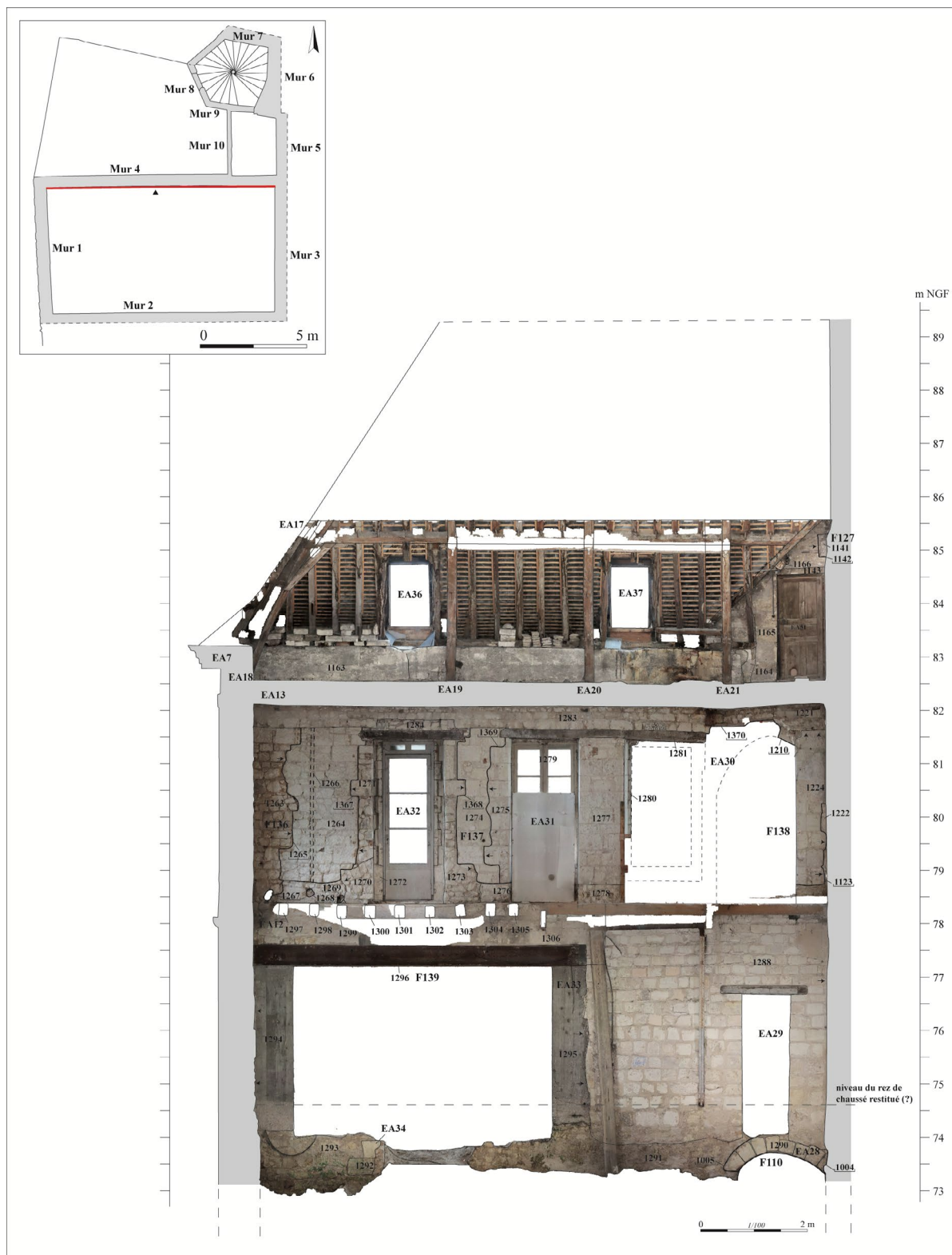
Figure 30. Lecture stratigraphique sur orthoimage de l'intérieur du Mur 4.
