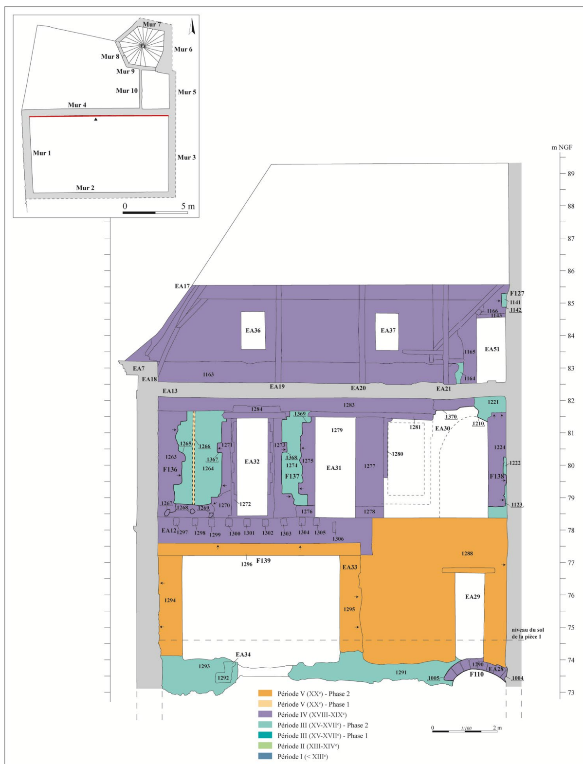
Figure 31. Lecture stratigraphique et phasage de l'intérieur du Mur 4.
